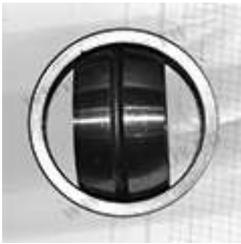
Подшипники шарнирные ГОСТ 3635-78 – относятся к подшипникам скольжения, наружное и внутреннее кольца которых имеют сферическую поверхность скольжения. Предназначены для восприятия и передачи радиальных, осевых и комбинированных нагрузок в подвижных или неподвижных соединениях различных машин и механизмов.
